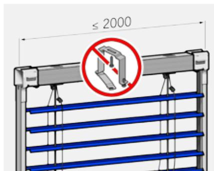
Autoportante senza ulteriore fissaggio, protegge l'isolamento ed è facile da applicare.
